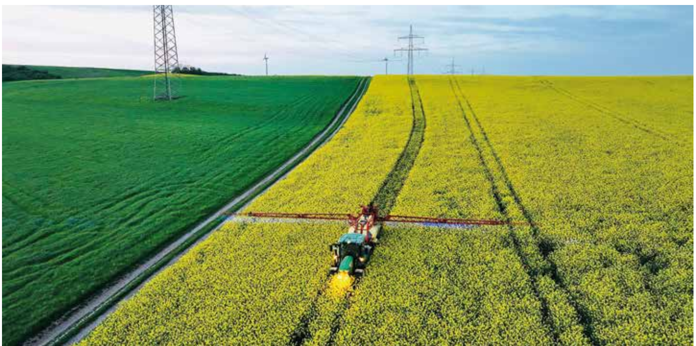
Drohnenaufnahme einer modernen Pflanzenschutzspritze mit 27 m Arbeitsbreite. Spritzung in der Abenddämmerung nach dem täglichen Bienenflug, Familie Schnitzler-Wolff.
