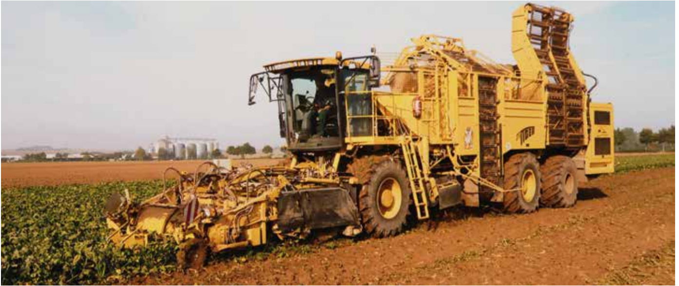
Sechsstufiger ROPA Rübenroder, hochmoderner, selbstfahrender Vollernter für Zuckerrüben, 2018
